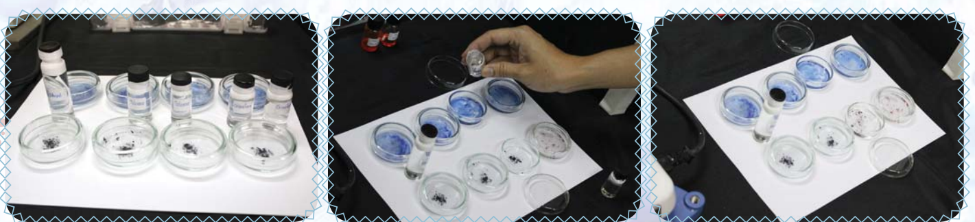
การทดสอบการตอบสนองโดยการเปลี่ยนสีของ PDA/ZnO Nanocomposites ต่อตัวทำละลายอินทรีย์ชนิดต่างๆ (solvatochromism)
